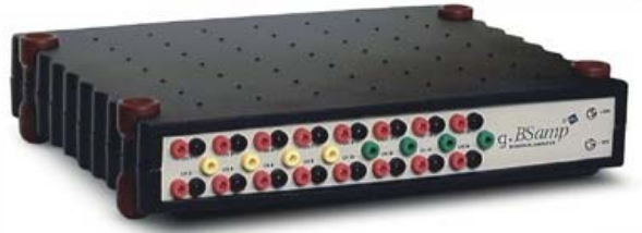
图 5 16 通道生物电放大器 (GT201 16 Channel Bio Amp)
