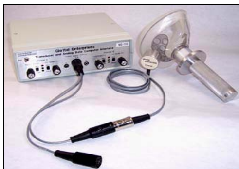
图 2 Glottal Enterprise 的气流气压计系统
